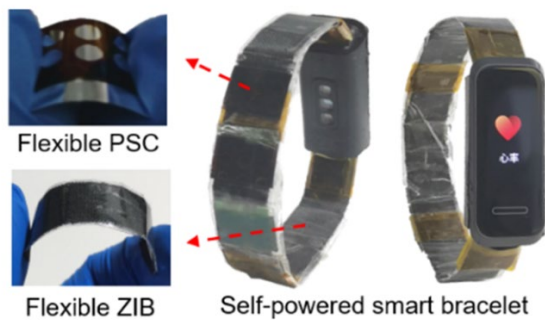
Διάγραμμα 27: Φωτογραφεία ενός ολοκληρωμένου συστήματος ΠΦΒ και εύκαμπτης μπαταρίας ενσωματωμένο σε έξυπνο ρολόι. «Πηγή»(Zhao et al. 2021)
