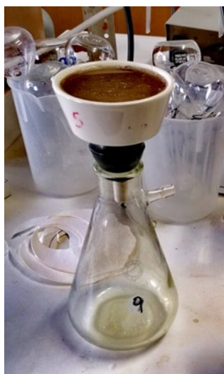
Εικόνα 9: Πειραματική διαδικασία για υπολογισμό SWHC.
