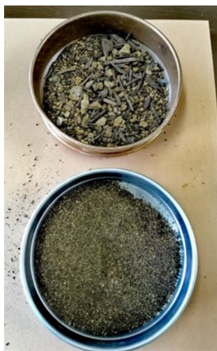
Εικόνα 8: Κοσκίνισμα δειγμάτων με την χρήση κόσκινου.
