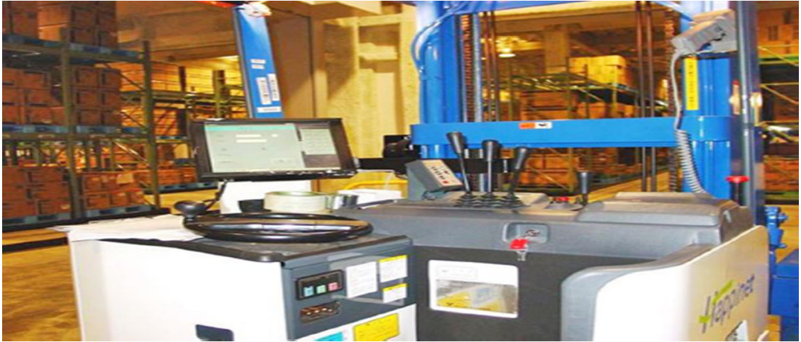
Διάγραμμα 10: Τερματικό δεδομένων RF τοποθετημένο σε όχημα με δυνατότητα οθόνης αφής. Πηγή: (Frazelle, 2017)
