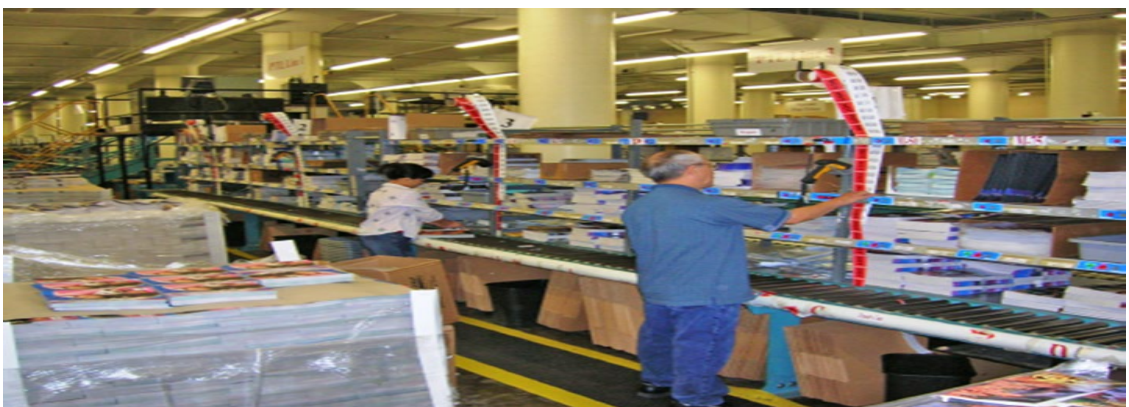
Διάγραμμα 11: Ανάληψη με τη μέθοδο κατευθυνόμενου φωτός (pick-by-light). Πηγή: (Frazelle, 2017)
