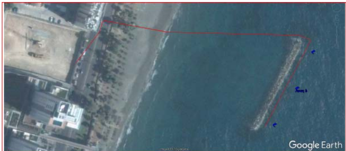
Χάρτης 8: Όδευση αγωγού νερού αποστράγγισης στη θάλασσα (Εργο 1) Πηγή: Διον. Τουμαζής & Συνεργάτες (2017)
