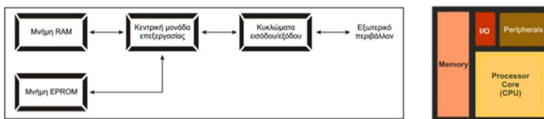
Σχήμα 4: Βασική δομή ενός μικροελεγκτή.
