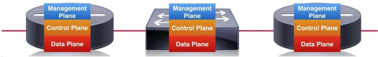
Εικόνα 1: Παραδοσιακή προσέγγιση λειτουργίας των τριών επιπέδων σε ένα δίκτυο.
