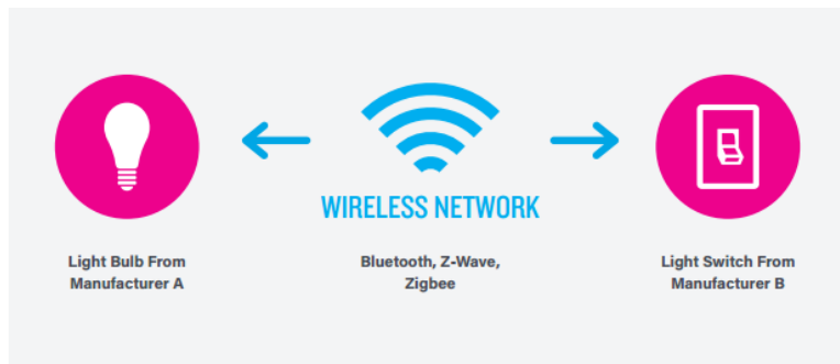
Σχήμα 1.2: Παράδειγμα του μοντέλου επικοινωνίας Device-to-Device [8]
