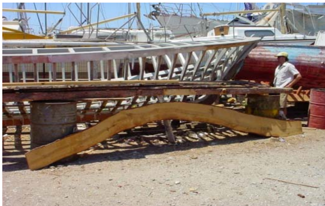
Εικόνα 6: Τα καμπύλα στοιχεία του σκελετού καϊκιών προέρχονταν από καμπύλους κορμούς πεύκου και κατάλληλα καμπύλα κλαδιά οριζοντιόκλαδου κυπαρισσιού (Κακαράς Ι. 2013).
