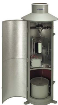
Σχήμα 2.13.2: Βροχογράφος τύπου Hellman
