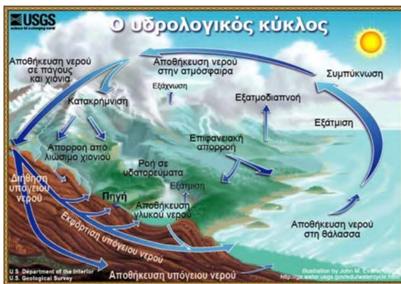
Σχήμα 2.7.1: Υδρολογικός κύκλος (Πηγή: www.usgs.gov Γεωλογική Υπηρεσία ΗΠΑ).
