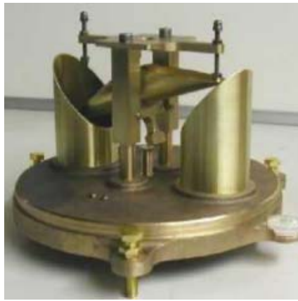
Σχήμα 2.13.3: Βροχόμετρο με tipping bucket (Silas, 2014)
