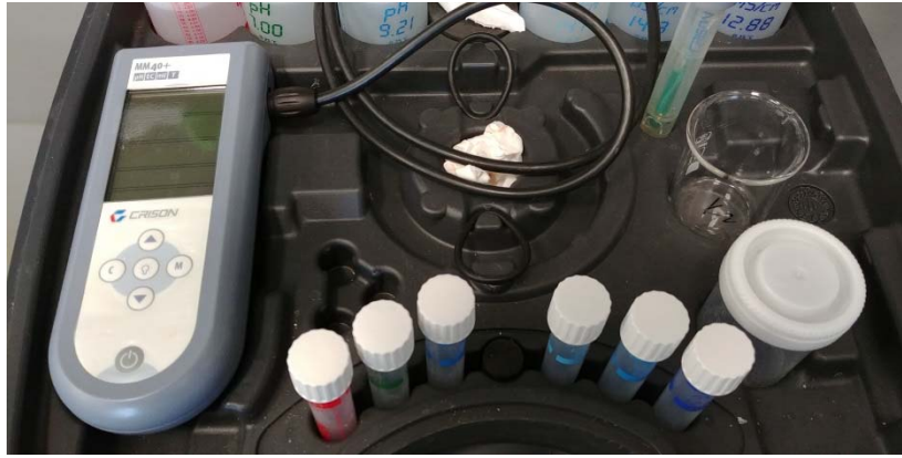
Εικόνα 3.3.4: Το πεχάμετρο που χρησιμοποιήθηκε για το προσδιορισμό του pH.
