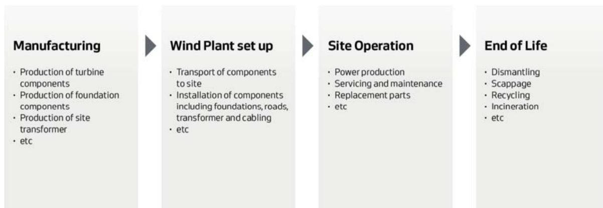
Διάγραμμα 6: Τα στάδια του κύκλου ζωής ενός τυπικού αιολικού σταθμού και οι τυπικές λειτουργικές δραστηριότητες.
