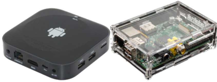
Εικόνα 22: Android box (αριστερά) και Raspberry Pi (δεξιά)
