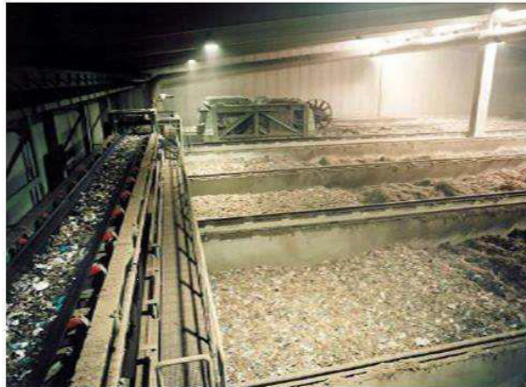
Εικόνα 2.3: Σύστημα κομποστοποίησης σε κιβώτια (αριστερά) και σε δεξαμενές (δεξιά) (Τμήμα Περιβάλλοντος, 2012)
