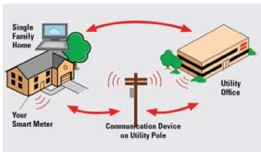
Εικόνα 3. Τρόπος λειτουργίας έξυπνου μετρητή και Αυτοματοποιημένης Υποδομής Μέτρησης (Πηγή: Spielberg 2017)
