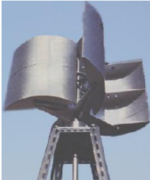
Εικόνα 2.13: Ανεμογεννήτρια Κατακόρυφου Άξονα τύπου Savonius (Πηγή: www.energybc.ca )
