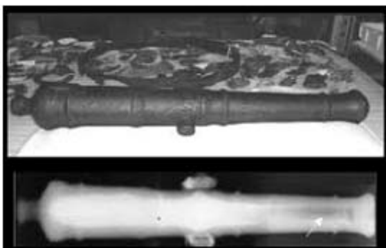
Εικόνα Δ.2.1 Κανόνι Ραδιογραφία ακτίνων Χ
