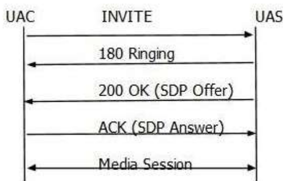
Σχήμα 11. Ανταλλαγή SDP στην μέθοδο ACK.
