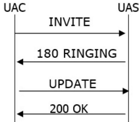
Σχήμα 15. Παράδειγμα της UPDATE πριν εγκαθιδρυθεί η συνεδρία.
