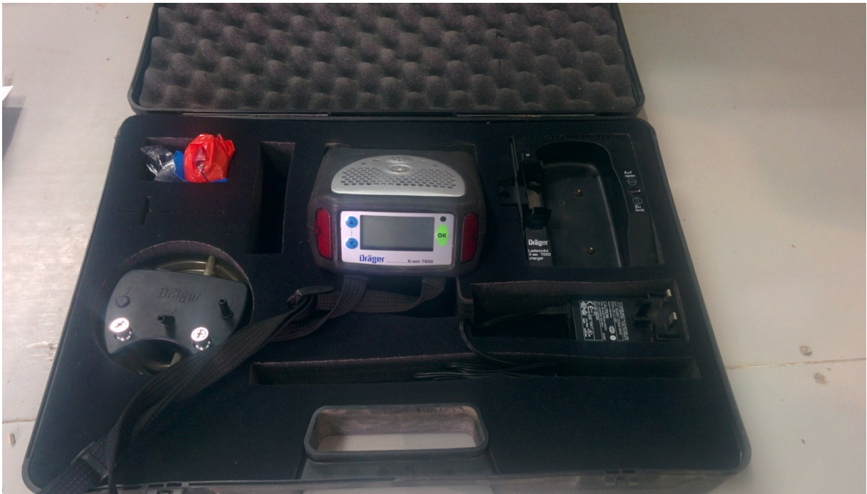
Εικόνα 3.2. Το όργανο μέτρησης σύστασης βιοαερίου DrägerSensor X-am 7000
