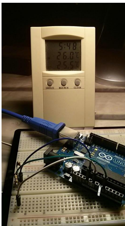
Εικόνα 19. Επιβεβαίωση μέτρησης με θερμόμετρο
