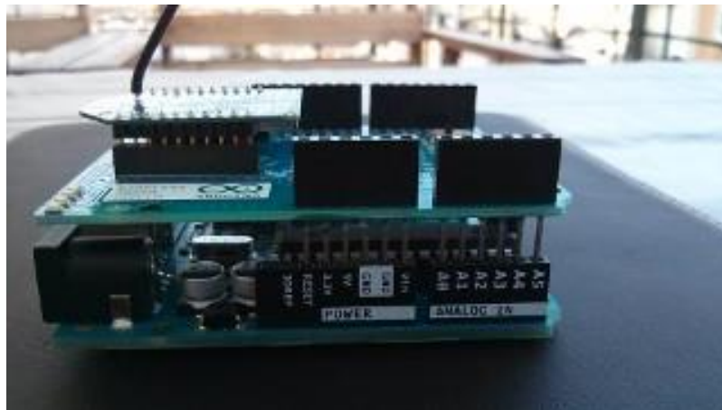
Εικόνα 23. Wireless Shield με module τοποθετημένο στο Arduino
