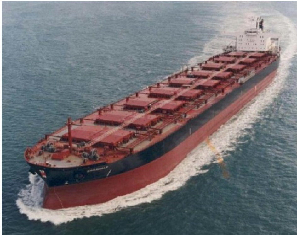
Εικόνα 2: Πλοίο μεταφοράς χύμα ομοειδών φορτίων (bulk carrier), πηγή: http://www.e-nautilia.gr/katigories-kai-eidi-ploiwn/
