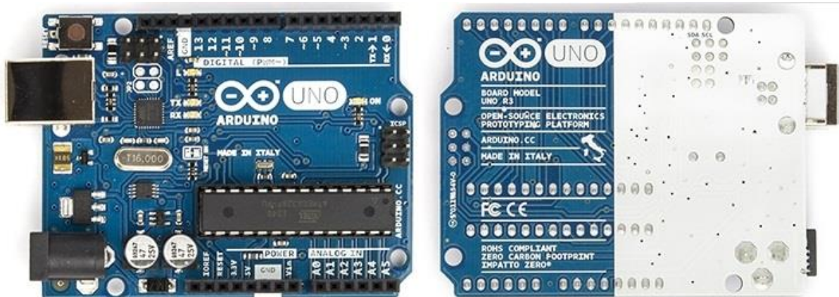
Σχήμα 5.2: Οι δυο όψεις (πάνω και κάτω) του Arduino Uno Rev3.
