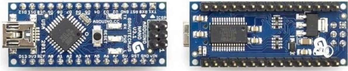
Σχήμα 5.3: Οι δυο όψεις (πάνω και κάτω) του Arduino Nano.
