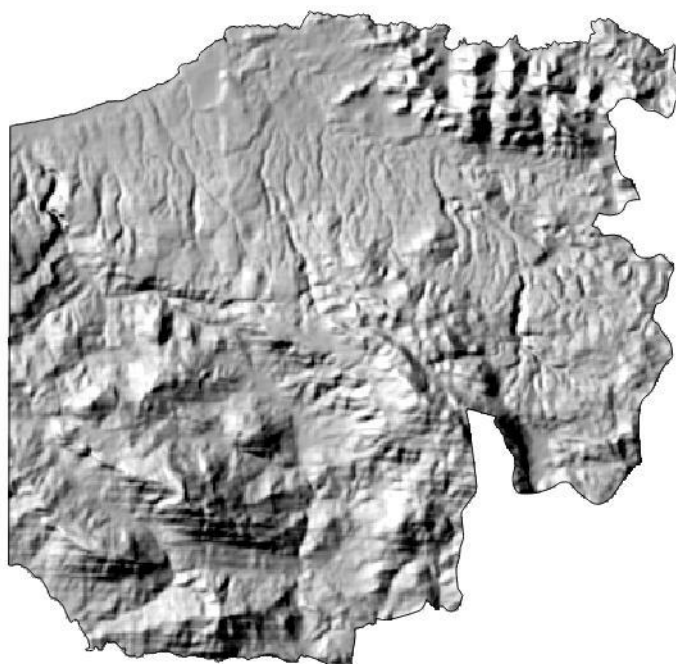
Σχήμα. 3.5.2.2 Χάρτης σκιασμένου ανάγλυφου (ύψος Ήλιου 40° αζιμούθιο 300° )
