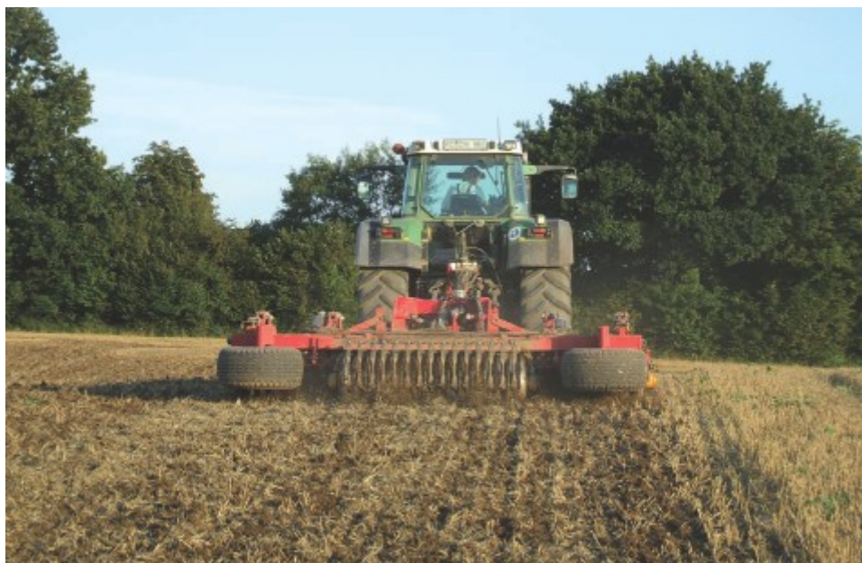
Σχήμα 4.4: Δισκοσβάρνα σε λειτουργία σε επιφανειακή κατεργασία του εδάφους (Πηγή: Agronotizie).
