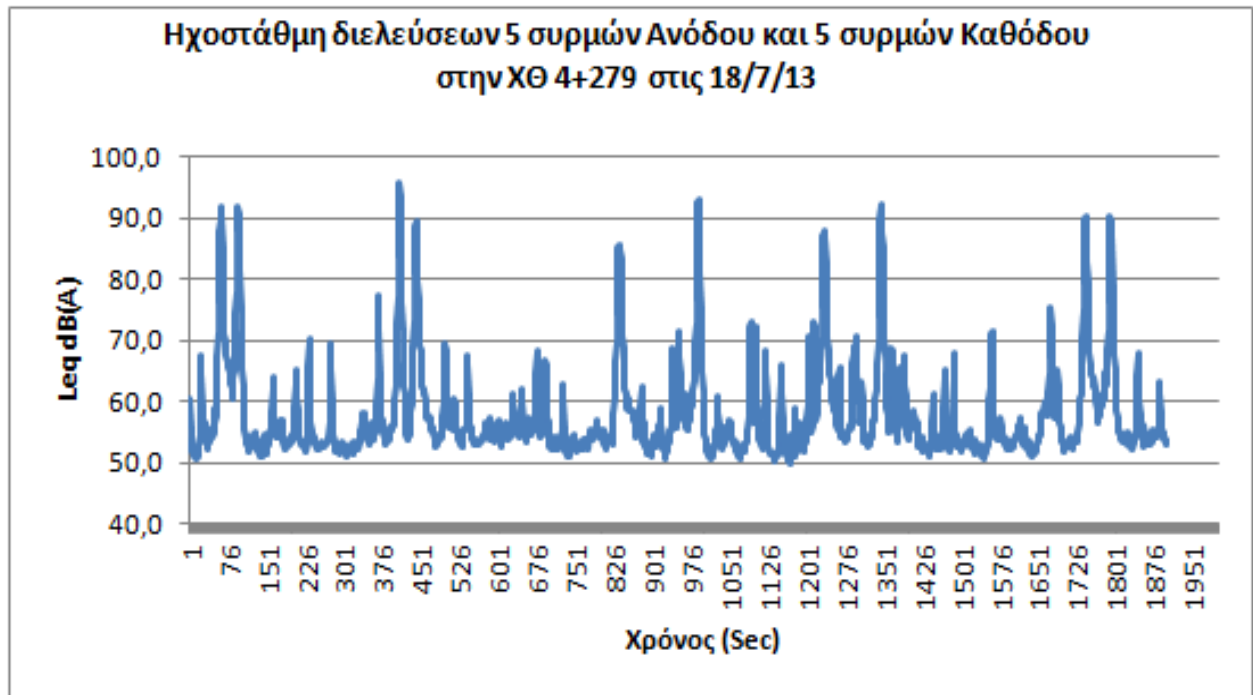
Εικόνα 4.54: Γραφική απεικόνιση χρονοσειράς ηχοστάθμης διελεύσεων 5 αωρμών ανόδου και καθόδου (Πηγή: Δ/ση Γραμμής & Έργων ΣΤΑΣΥ/ΗΣΑΠ).
