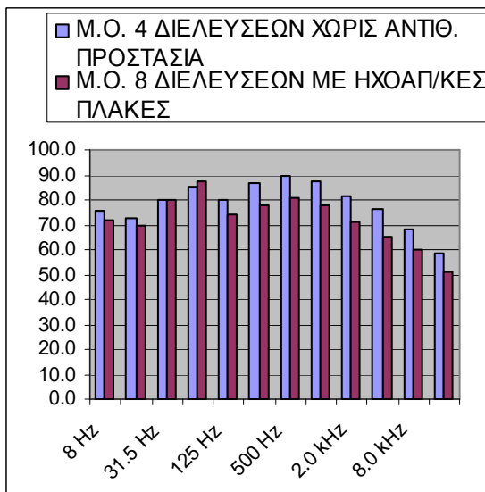
Εικόνα 4.31: Γραφικές απεικονίσεις των αποτελεσμάτων των μετρήσεων με ελεγχόμενη ταχύτα συρμών σε σταθερή επιδομή χωρίς (60-63) και με (64-71) αντιθρομβική προστασία τύπου ηχοαπορροφητικές πλάκες.
