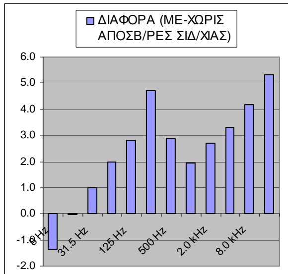
Εικόνα 4.32: Γραφικές απεικονίσεις των αποτελεσμάτων των μετρήσεων με ελεγχόμενη ταχύτα συρμών σε σταθερή επιδομή χωρίς (μετρήσεις 2/2010) και με αντιθρομβική προστασία τύπου αποσβεστήρας σιδηροτροχιάς.
