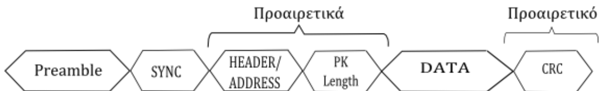
Εικόνα 3.10 Δομή πακέτου με ενεργοποιημένη τη λειτουργία PH
