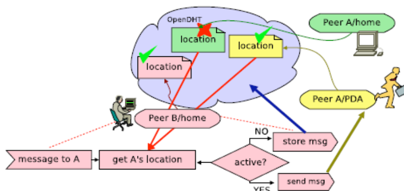
Σχήμα 3.2: Αποστολή μηνύματος από το ομότιμο Β σύστημα στο ομότιμο Α σύστημα [05].
