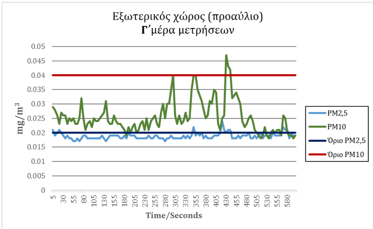
Διάγραμμα 5.21: Δεκάλεπτη Μέτρηση Αιωρούμενων Σωματιδίων ανά 5 sec στον Εξωτερικό Χώρο (προαύλιο) του κτιρίου Δημόσιας Υπηρεσίας
