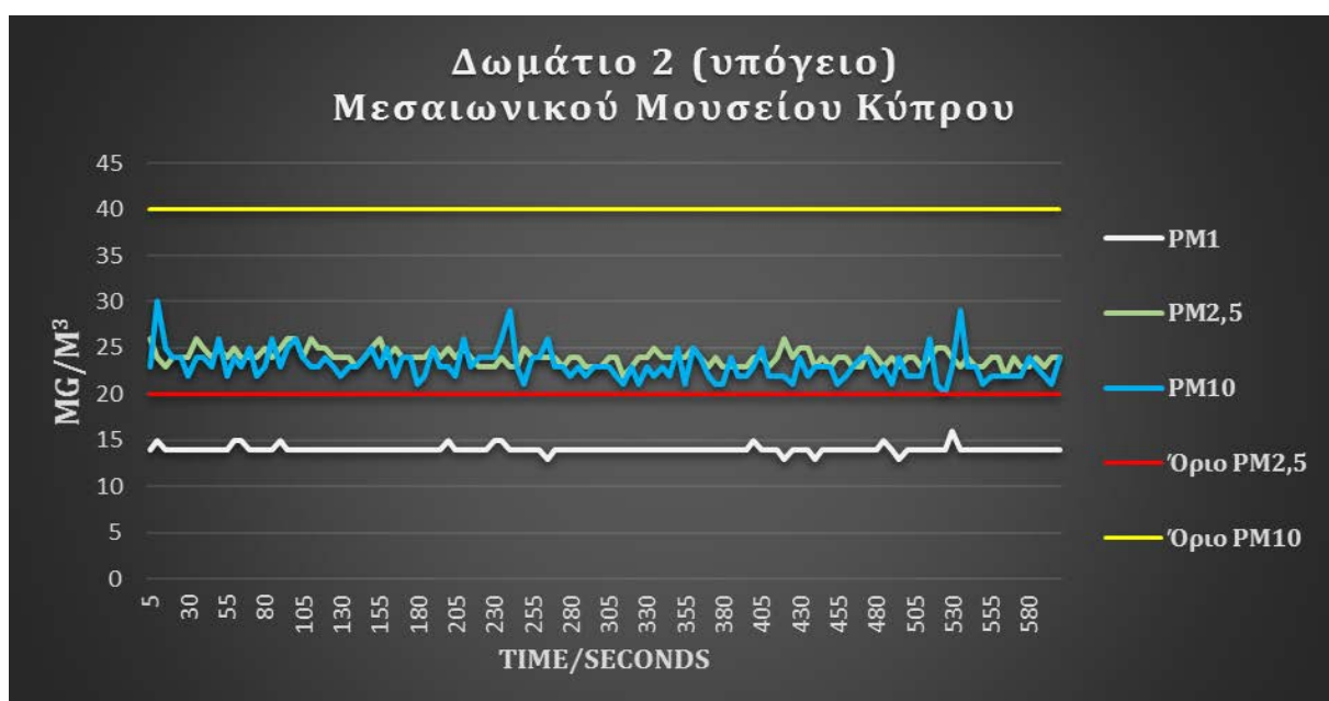
Διάγραμμα 6.5: Σύγκριση Μετρήσεων Αιωρούμενων Σωματιδίων Δωματίου 2 (υπόγειο) Μεσαιωνικού Μουσείου Κύπρου με το εθνικό αποδεκτό όριο της Κυπριακής Δημοκρατίας
