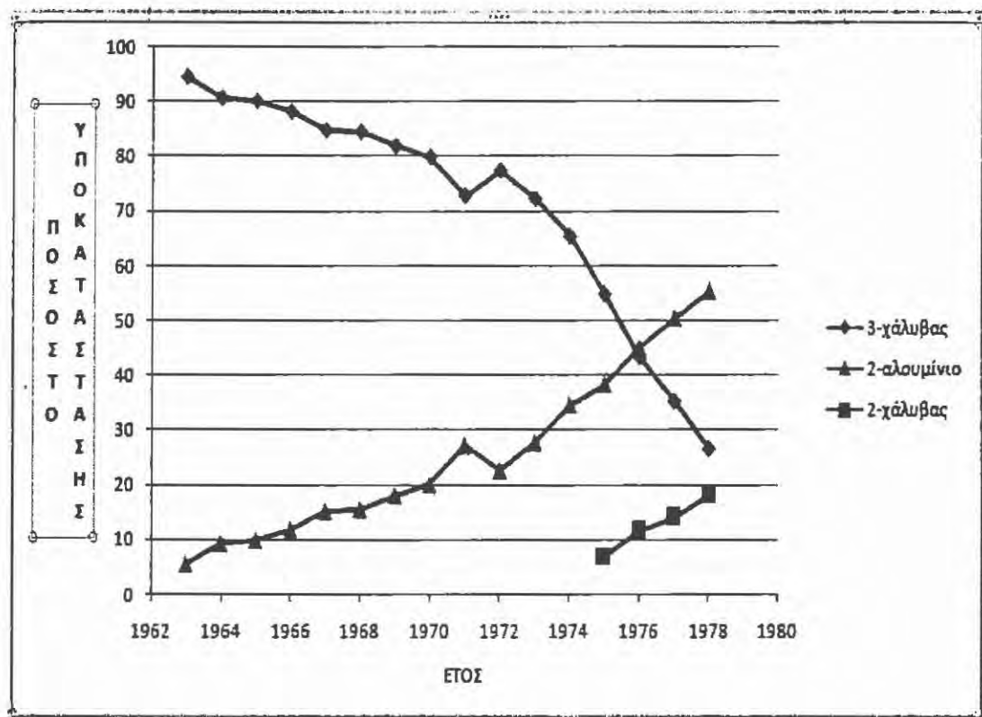
Σχήμα 1.12: Η υποκατάσταση της τεχνολογίας τρία μέρη συγκολλημένα για την κατασκευή των μεταλλικών δοχείων, από την τεχνολογία δυο μέρη. Η χρήση του αλουμινίου στην τεχνολογία, δεν υποκαθίσταται από την χρήση του χάλυβα που εμφανίζεται το 1975
