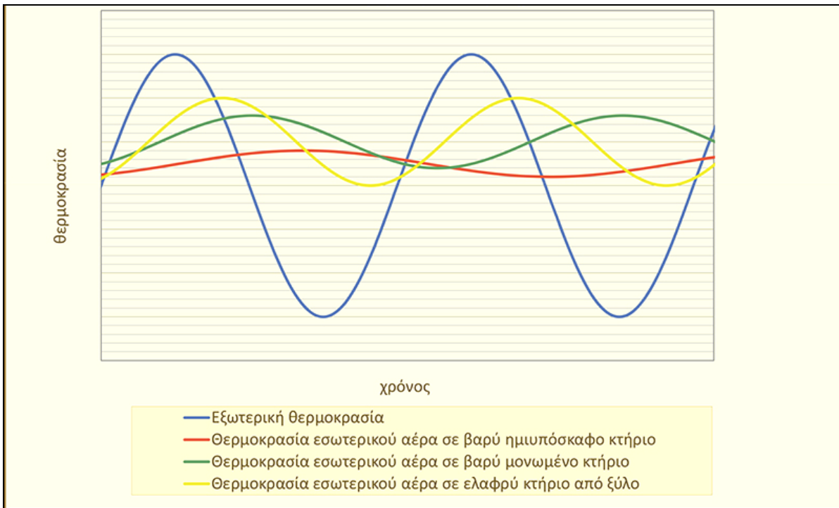
Εικόνα 3.7 Επίδραση της θερμικής μάζας στη διακύμανση της εσωτερικής θερμοκρασίας (Ανδρεαδάκη – Χρονάκη Ε., 2006).
