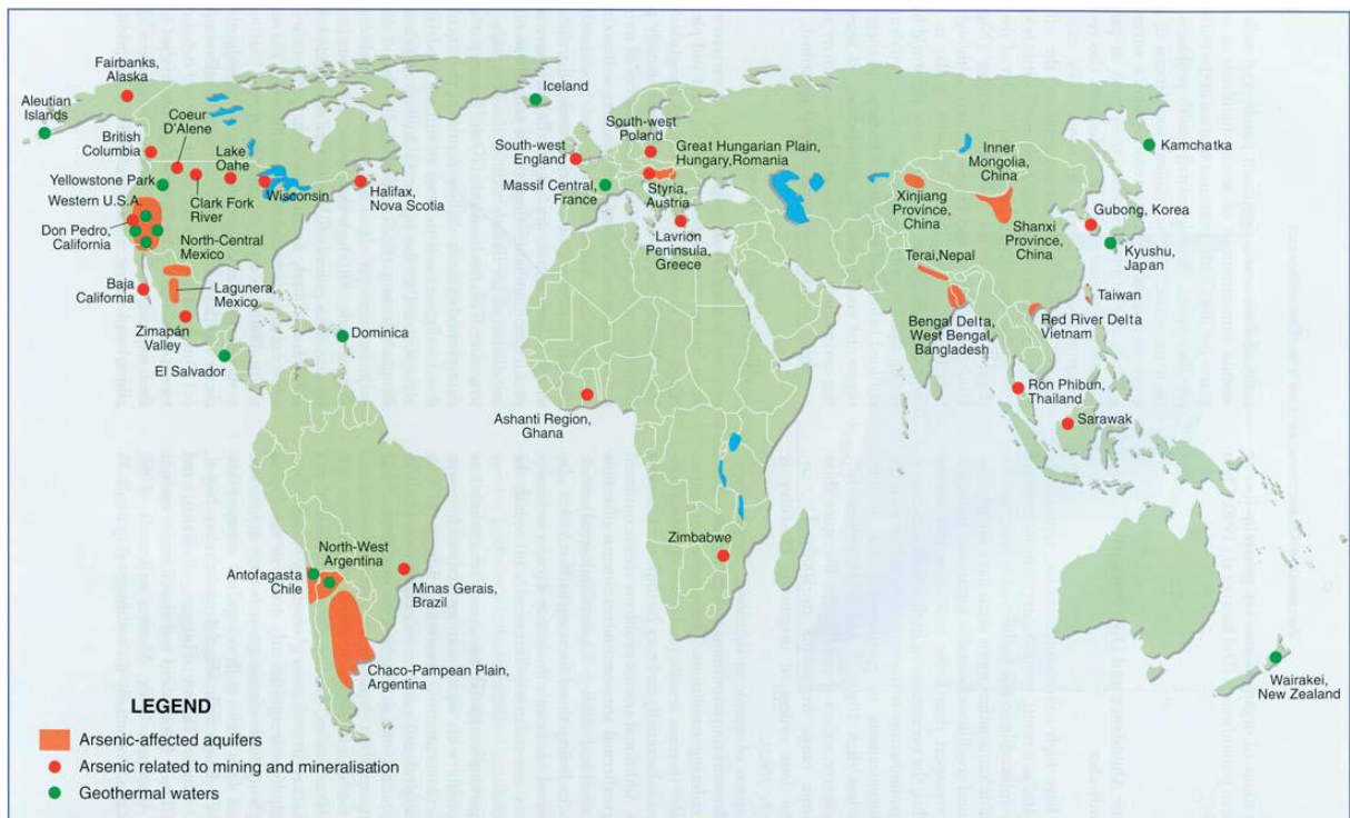
Εικόνα 2.6.6.1 Παγκόσμιος χάρτης με απεικόνιση των περιοχών με τεκμηριωμένα προβλήματα υψηλής συγκέντρωσης As σε υδροφορείς (Centeno et al., 2007)
