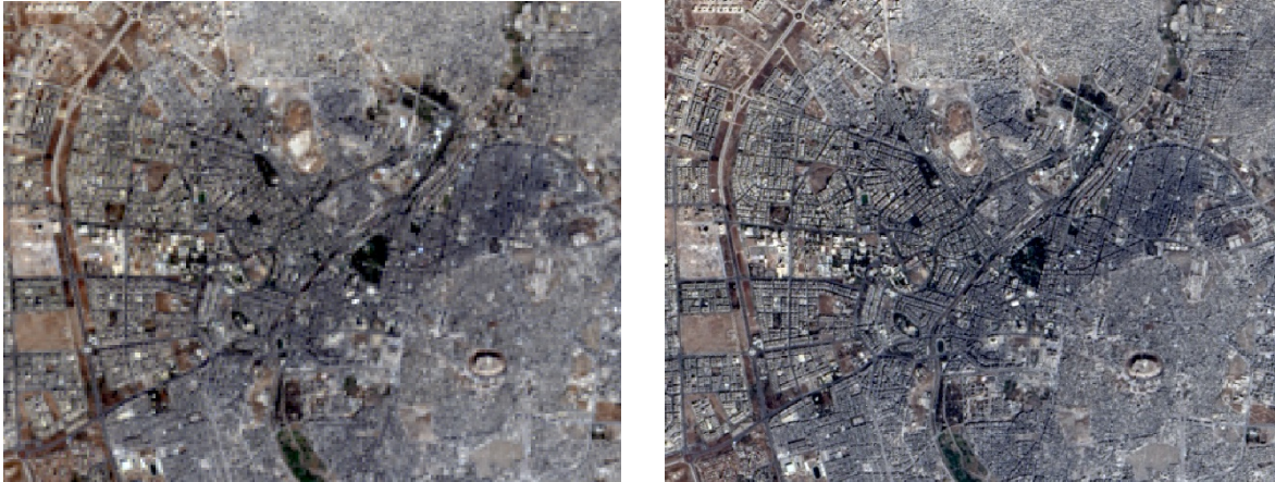
Εικόνα 10 Τμήμα φωτοσύνθετου ψευδοχρώματος πριν και μετά την εφαρμογή του αλγόριθμου Brovey για τον Οκτώβρη του 2017.
