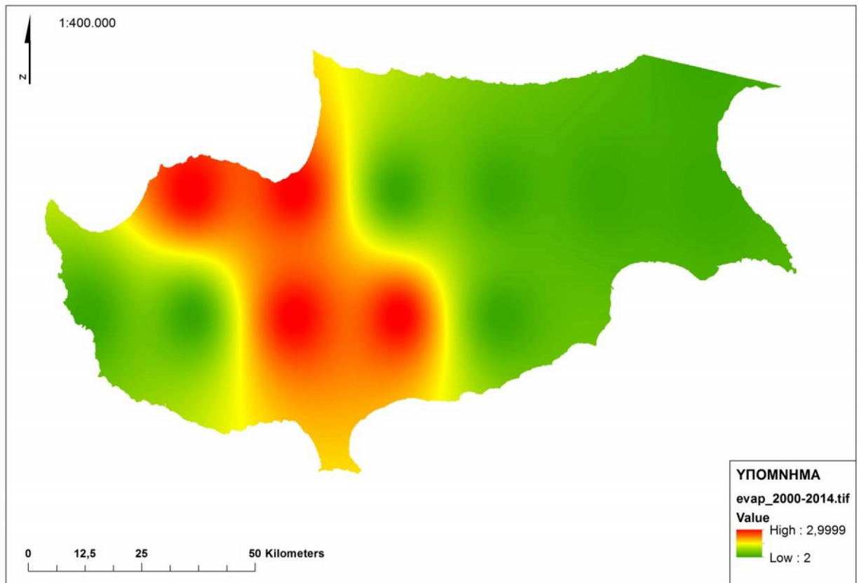
Εικόνα 3.31. Το ψηφιακό πλεγματικό αρχείο της συνολικής εξατμισιοδιαπνοής στην περιοχή μελέτης, την περίοδο 2000 – 2014 μεγέθους εικονοστοιχείου 100 m
