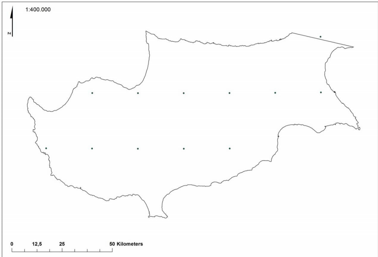
Εικόνα 3.13. Το Διανυσματικό αρχείο, δορυφορικό προϊόν με τα κέντρα των pixel που βρίσκονται εντός της περιοχής μελέτης, στο οποίο υπάρχει ενσωματωμένη η πληροφορία της συνολικής εξατμισιοδιαπνοής για το χρονικό διάστημα 2000 – 2014
