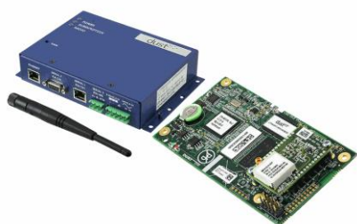
Εικόνα 52. Μία συσκευή Διαχειριστής Δικτύου (Network Manager) (NM) του WirelessHART. Κατασκευαστής: dust. Πηγή: http://www.digikey.com/
