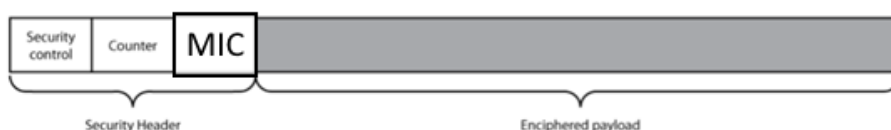
Εικόνα 102. Το πεδίο MIC στο πακέτο δεδομένων του υπο-επιπέδου ασφαλείας.
