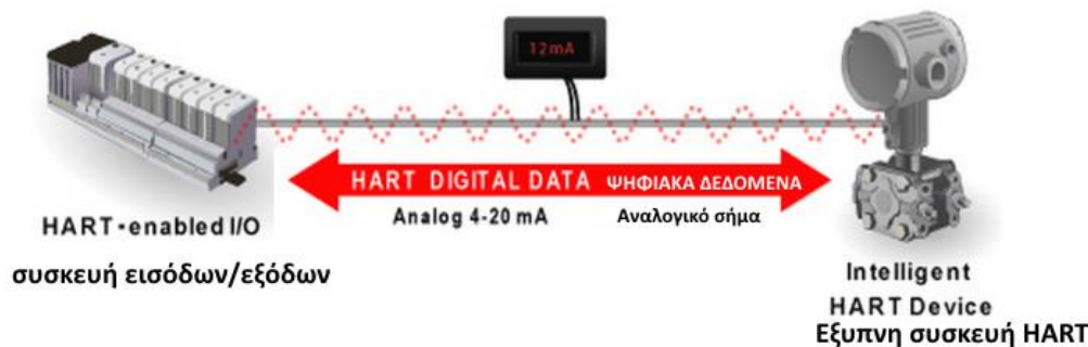
Εικόνα 34. Το HART μεταφέρει ταυτόχρονα ένα αναλογικό σήμα και ένα ψηφιακό σήμα. Πηγή: [19]
