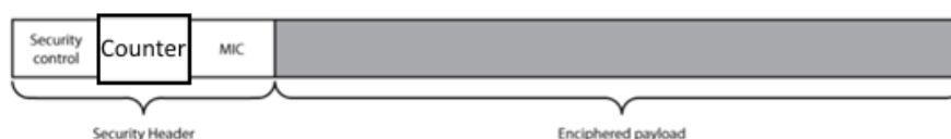
Εικόνα 101. Το πεδίο του μετρητή nonce counter στο πακέτο δεδομένων του υπο-επιπέδου ασφαλείας.
