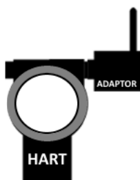
Εικόνα 71. Σύνδεση σημείο προς σημείο. Όργανο HART 4-20 mA που ο adaptor έχει τροφοδοσία από βρόχο ή από μπαταρία και έχει εγκατασταθεί στην ίδια γραμμή πάνω στο βρόχο που συνδέεται το όργανο.
