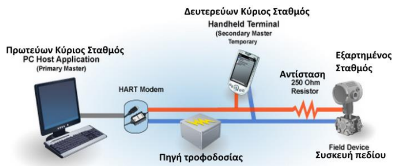
Εικόνα 37 Πρωτεύων κύριος σταθμός (primary master) και δευτερεύων κύριος σταθμός (secondary master) σε σύνδεση σημείο προς σημείο point-to-point. πηγή [19].
