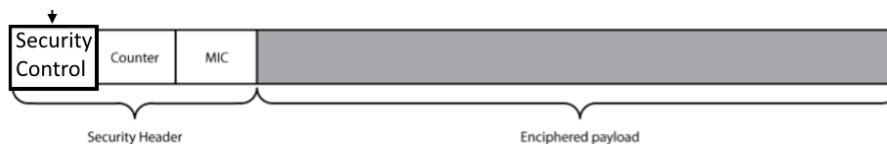
Εικόνα 99 Το 1ο byte είναι το πεδίο ελέγχου ασφαλείας (Security Control).
