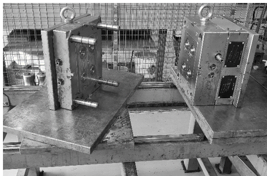
Σχήμα 42: Συρόμενος μηχανισμός για εύκολο άνοιγμα καλουπιών
