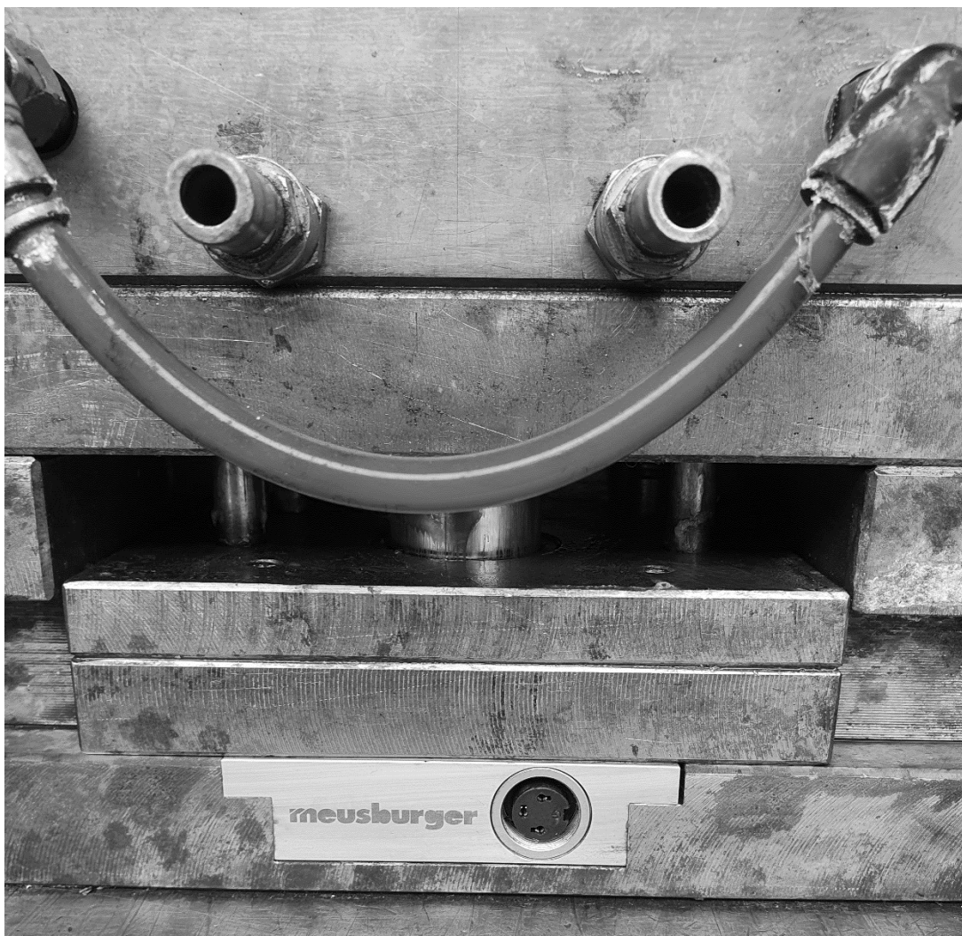
Σχήμα 34: Εγκατεστημένος τερματικός διακόπτης προστασίας στην πλάκα εξολκεία
