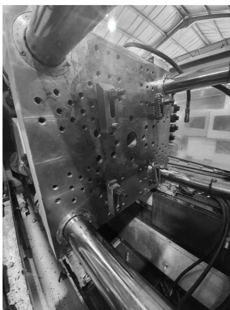
Σχήμα 22: Διαφορετικού τύπου στηρίγματα στην ίδια πλάκα μηχανής
