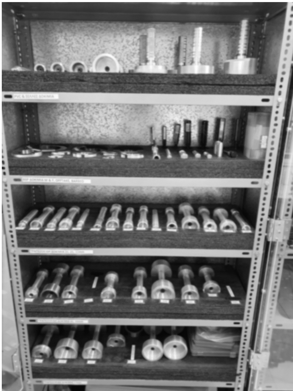
Σχήμα 35: Χώρος αποθήκευσης ελεγκτήρων ποιότητας
