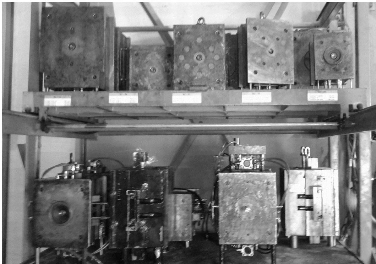
Σχήμα 32: Τοποθέτηση καλουπιών σε κωδικοποιημένες θέσεις
