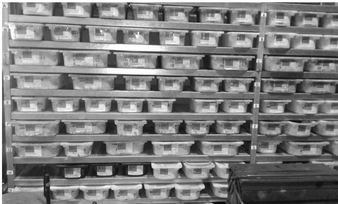
Σχήμα 33: Τοποθέτηση εξαρτημάτων καλουπιών σε κωδικοποιημένες θέσεις
