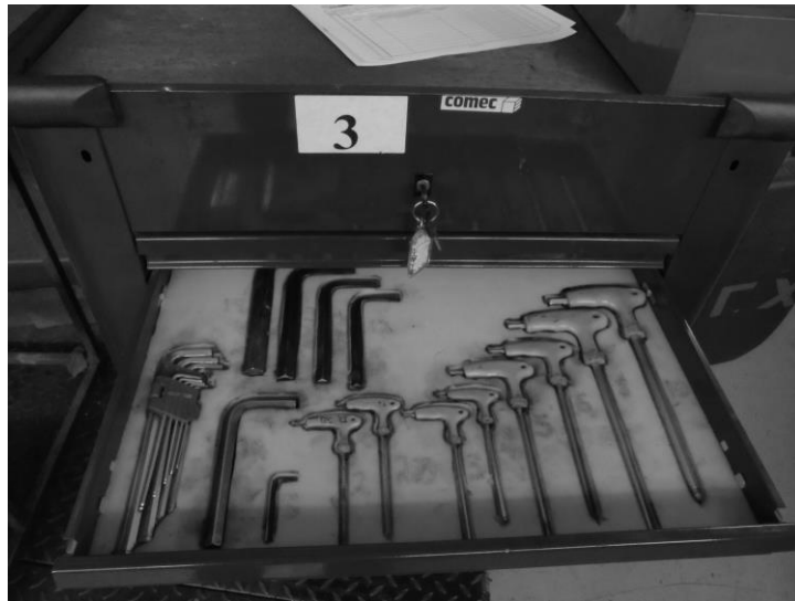
Σχήμα 41: Θέσεις εργαλείων σε αφρώδες υλικό
