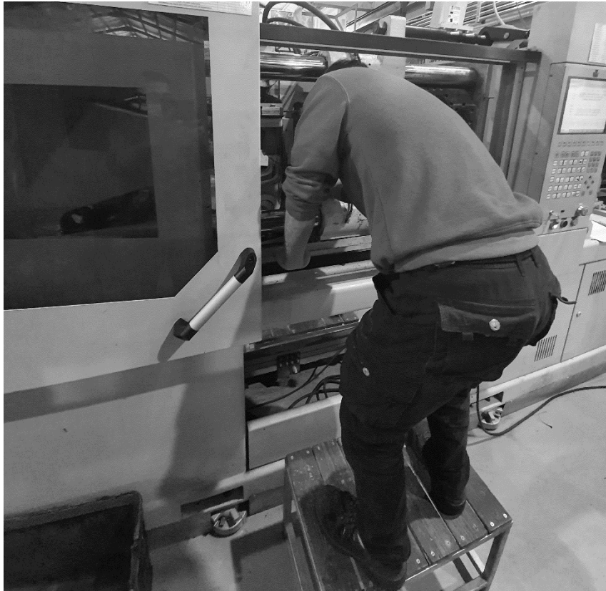
Σχήμα 23: Τεχνικός κατά την αποσυναρμολόγηση εξολκέα
