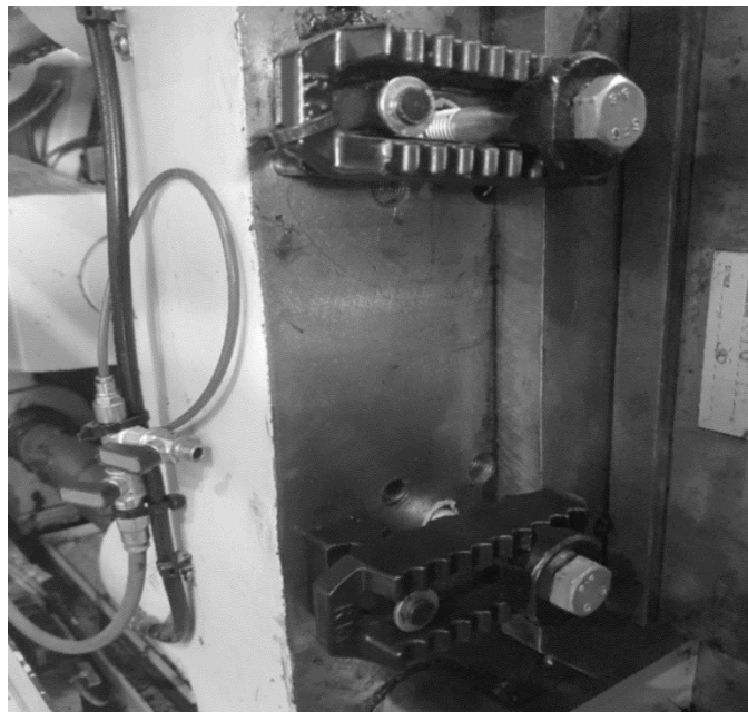
Σχήμα 37: Πρόσδεση καλουπιού στην μηχανή με τις τυποποιημένες πλάκες και στηρίγματα
