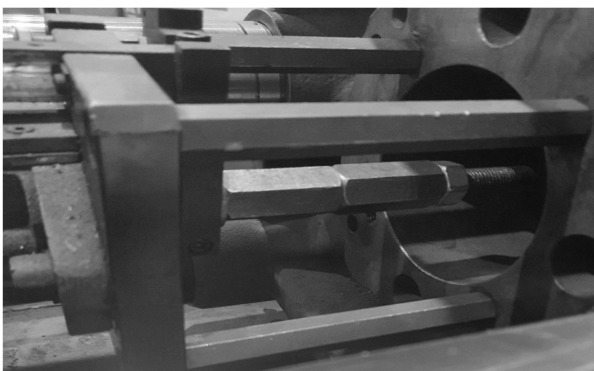
Σχήμα 26: Σύνδεσμος εξολκέα μηχανής και καλουπιού
