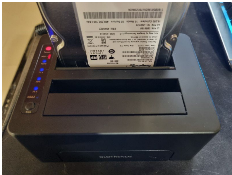
Εικόνα 5-2: Εργαλείο 1 - Διαγραφή δίσκου με χρήση συσκευής GLOTTREND 2-in-1 SATA Hard Drive Eraser
