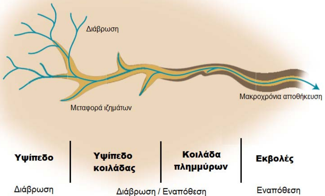
Εικόνα 5: Διάγραμμα των βασικών ζωνών γεωμορφολογικών διεργασιών σε λεκάνη απορροής. Οι ορεινές περιοχές του υδροφόρου ορίζοντα είναι κατά κύριο λόγο διαβρωτικές ζώνες, ενώ τα μεσαία τμήματα είναι επί το πλείστον ζώνες μεταφοράς όπου η διάβρωση και η εναπόθεση σχεδόν ισορροπούν. Τα χαμηλότερα τμήματα ποταμών κοντά στο επίπεδο της θάλασσας είναι κατά κύριο λόγο εναποθετικές ζώνες (τροποποίηση από Naiman et al., 2005).
