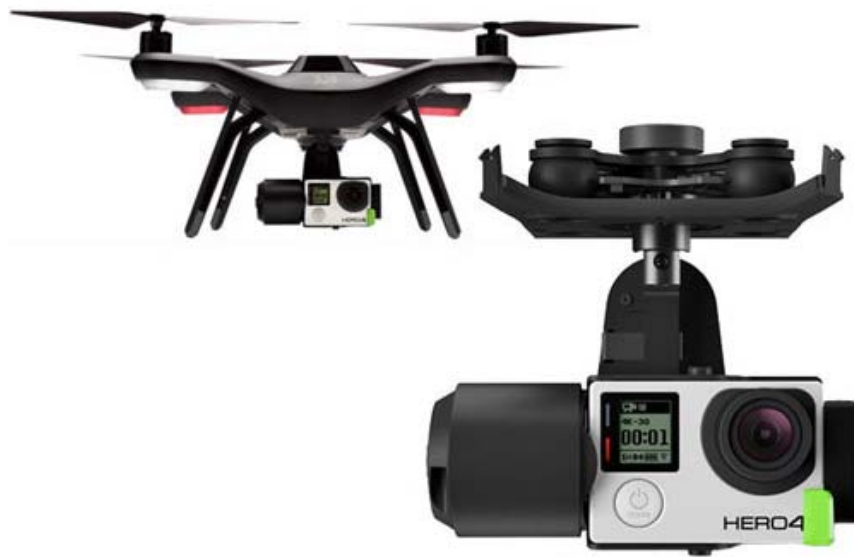
Εικόνα 17. Η GoPro Hero 4Black προσαρμοσμένη στον βραχίονα του τετρακόπτερου Μη Επανδρωμένο Ιπτάμενο Όχημα (Μ.Ε.Ι.Ο.) 3DR SOLO
