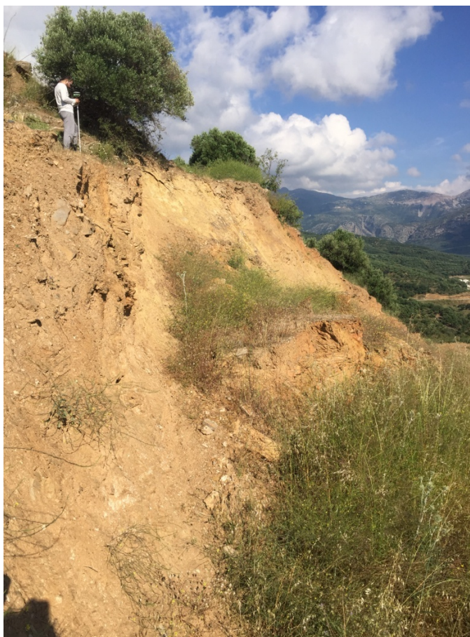
Εικόνα 9. Τοπογραφική αποτύπωση στο φρύδι της κατολίσθησης (Γεω. Περ. Σύμβουλοι Μηχανικοί Α.Ε., 2017)
