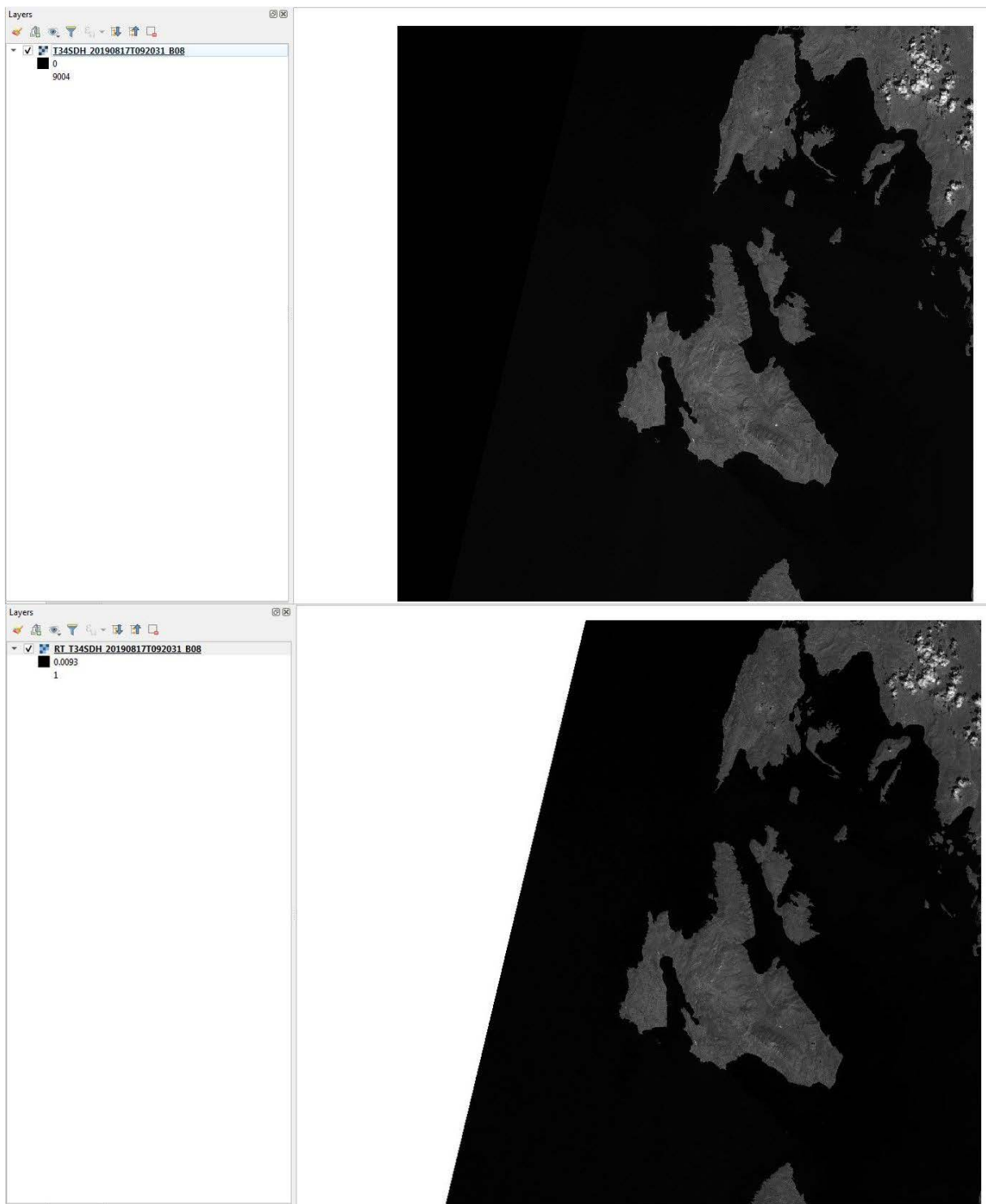
Εικόνα 3.3.1.5: Κανάλι B08 πριν και μετά την εφαρμογή της τεχνικής DOS1
