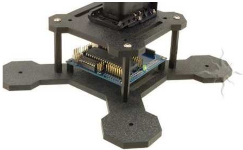
Σχήμα 48: Κάρτα Ελέγχου ArbotiX Robocontroller Τοποθετημένη στο PhantomX Robot Turret
