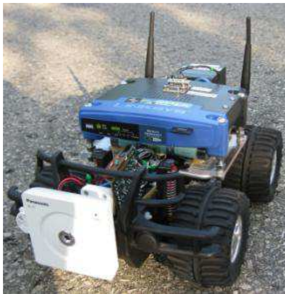
Σχήμα 55: Linksys WRT-54GL V1.1 router σε Αυτόνομο Ρομπότ
