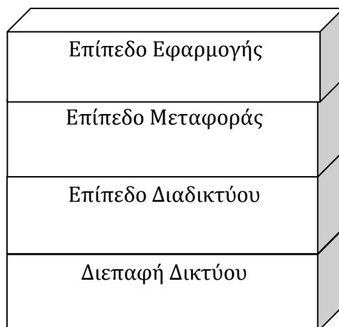
Εικόνα 2. 2 Το TCP/IP μοντέλο
