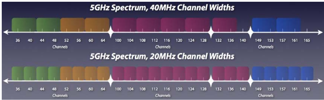
Σχήμα 2-10 Κανάλια του 802.11.n, στη ζώνη συχνοτήτων 5GHz και για εύρη καναλιών 20 και 40MHz.
