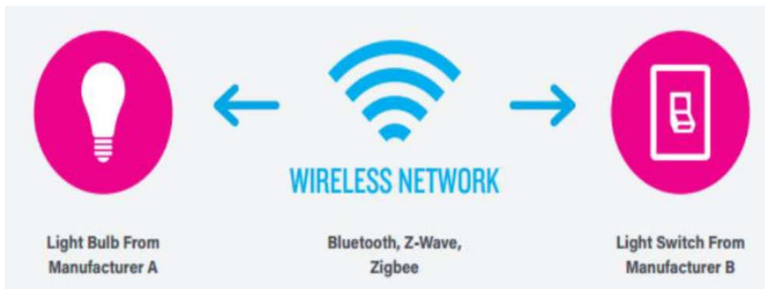
Εικόνα 12. Μοντέλο επικοινωνίας Device-to-Device
