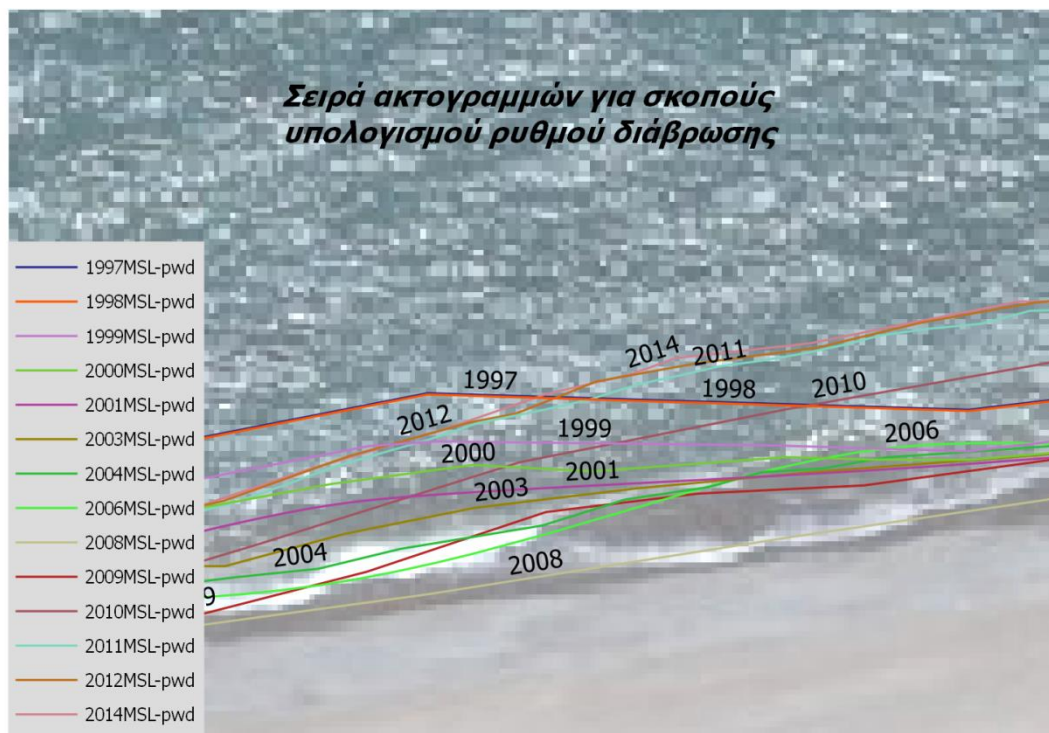
Εικόνα 4.3: Θεματικός χάρτης με τις ετήσιες ακτογραμμές που λήφθηκαν υπόψη για σκοπούς υπολογισμού του ρυθμού διάβρωσης στην περιοχή μελέτης (πηγή φωτογραφίας υπόβαθρου Google earth)
