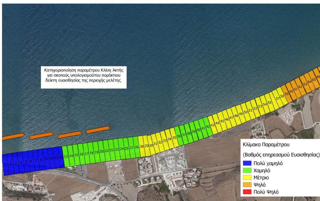
Εικόνα 4.12: Θεματικός χάρτης με την κατηγοριοποίηση της ακτής σε σχέση με την παράμετρο κλίση ακτής (πηγή φωτογραφίας υποβάθρου Google earth) .
