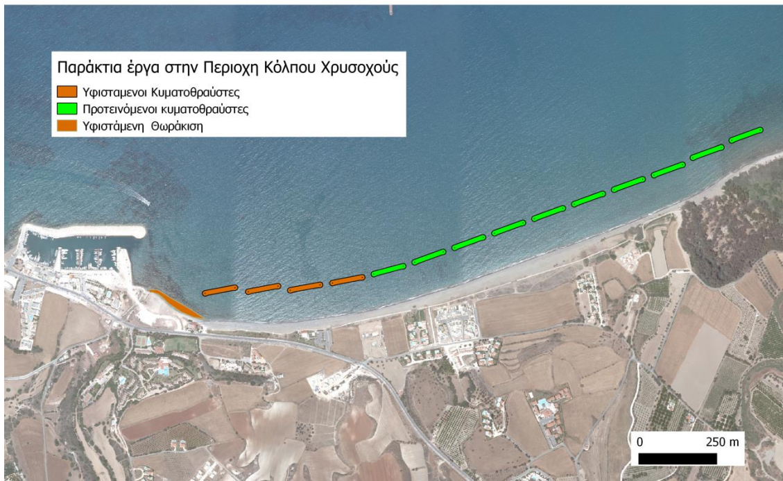
Εικόνα 3.21: Υφιστάμενα και προτεινόμενα έργα προστασίας (ΤΔΕ, 2017α) (πηγή φωτογραφίας υπόβαθρου Google earth)
