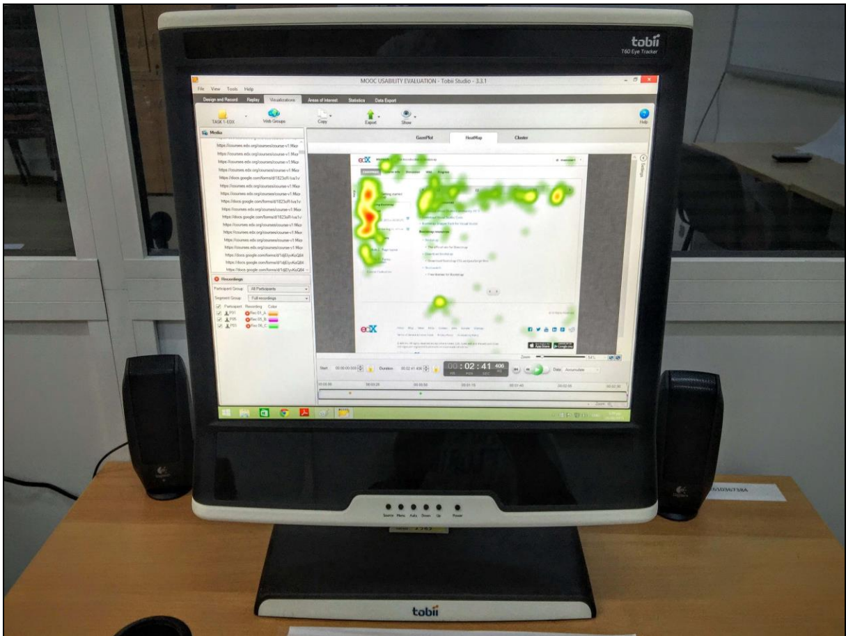
Εικόνα 4.5: Ο σταθερός Tobii Eye-Tracker του Εργαστηρίου Ποιότητας Λογισμικού
