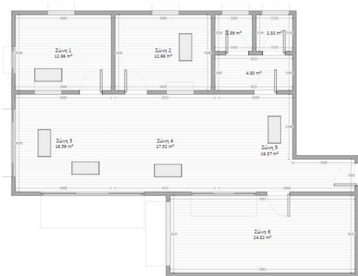
Εικόνα 6. Ζώνες κλιματισμού σε συνάρτηση με τους ενοίκους
