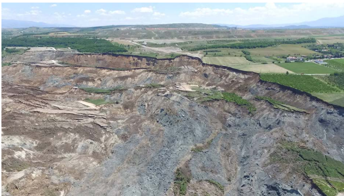
Εικόνα 3: Κατολίσθηση Αμυνταίου, διακρίνεται το μέτωπο εξόρυξης του ορυχείου της ΔΕΗ μήκους 3 km (10 Ιουνίου 2017). Πηγή: Γιώργος Τσομπανάκης, λήψη από drone.
