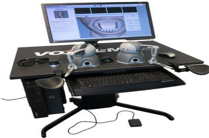
Εικόνα 8. Voxel – Man, προσομοιωτής εικονικής πραγματικότητας για την εκπαίδευση οδοντιάτρων αλλά και ωτοχειρουργών στην εκσκαφή κροταφικού οστού.
