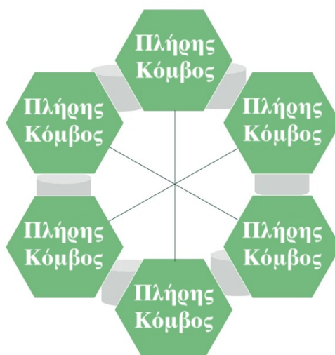
Εικόνα 5.1. Γραφική απεικόνιση της διάταξης Πλήρων Κόμβων εντός ενός συστήματος κρυπτονομίσματος (Longchamp, Deshpande, & Mehra, 2020).
