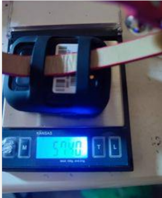
Εικόνα 3.5: Το προστατευτικό περίβλημα της συσκευής διαθέτει σημείο που περνά το κολλάρο. Όλος ο εξοπλισμός μαζί με το περίβλημα έχει συνολικό βάρος 57,40 γραμμάρια. Αυτό υποδεικνύει ότι μπορεί να χρησιμοποιηθεί σε γάτα με ελάχιστο βάρος τα 1,160 γραμμάρια.
