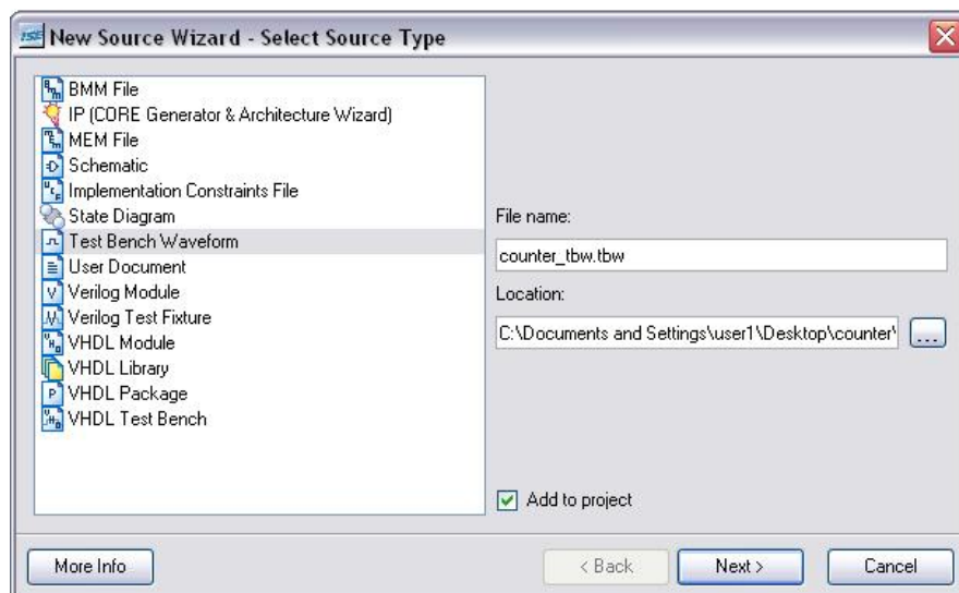
Εικόνα Δ.10: Επιλογή «πάγκου εργασίας» Test Bench από το πρόγραμμα CAD ISE
