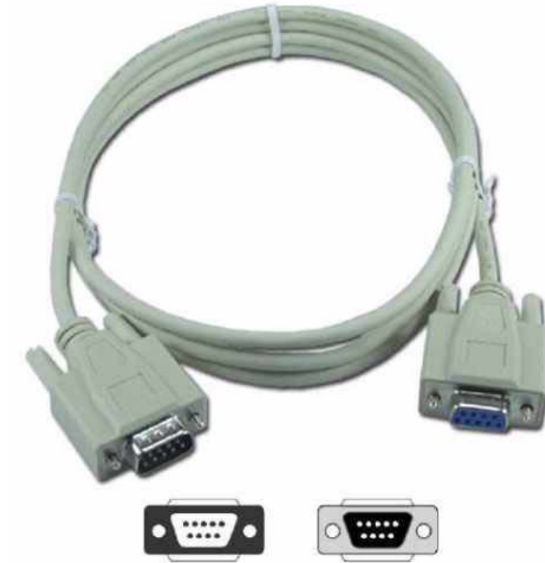
Εικόνα 4.31: Καλώδιο RS232 με αρσενικό και θηλυκό προσαρμογέα
